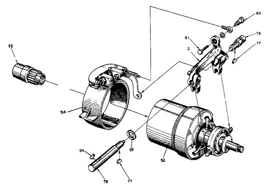
TOGGLE OPERATED REVERSE BAND ASSEMBLY STANDARD
