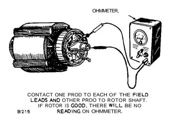
FIGURE 16, TESTING ROTOR FOR GROUNDS
