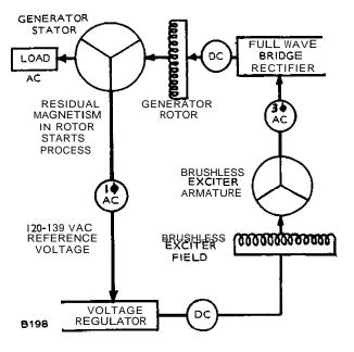
FIGURE 3. EXCITATION BLOCK DIAGRAM
