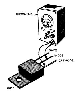
FGURE 12. SCR RESISTANCE TEST
