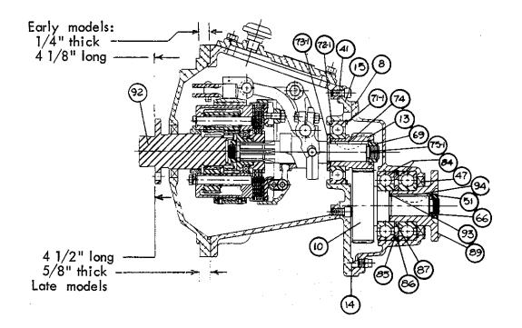
DISASSEMBLY OF THE REVERSE BAND-TOG-GLE OPERATED TYPE
