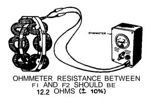
FIGURE 14. TESTING EXCITER FIELD
